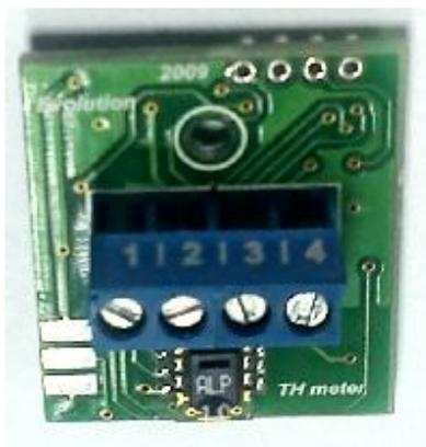
**Рисунок 1. Вид датчика без корпуса.**
